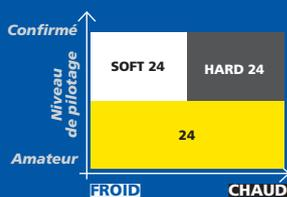
Combiner l'arrière MICHELIN POWER PERFORMANCE 24 avec un pneu avant 120/70 R 17 MICHELIN POWER PERFORMANCE SLICK. Choisir le cran en fonction des conditions d'utilisations ci-dessous :
